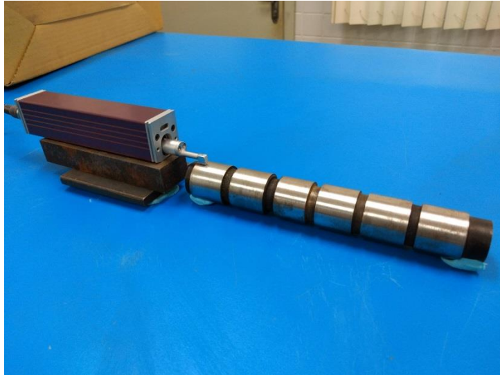
Figura 3.5 – Ensaio de rugosidade utilizando o rugosímetro portátil Surftest SJ-210
